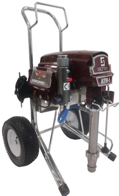
Установка безвоздушного распыления АТМ-5 с электрическим мотором на 220В оснащен мощным бесщеточным двигателем мощностью 2800 Вт и поршневым штоком LONG. Данная установка предназначена для всех видов профессиональных работ по окраске. С легкостью справится с большим объемом работ. К окрасочному аппарату ST-500TX возможно подключить одновременно два окрасочных поста.
